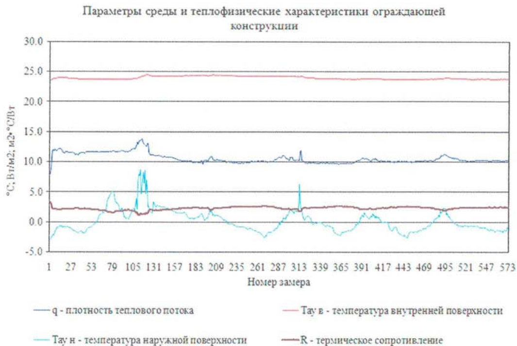
Рисунок 10. Теплофизические характеристики радиаторных участков наружных стен до установки отражающих экранов
