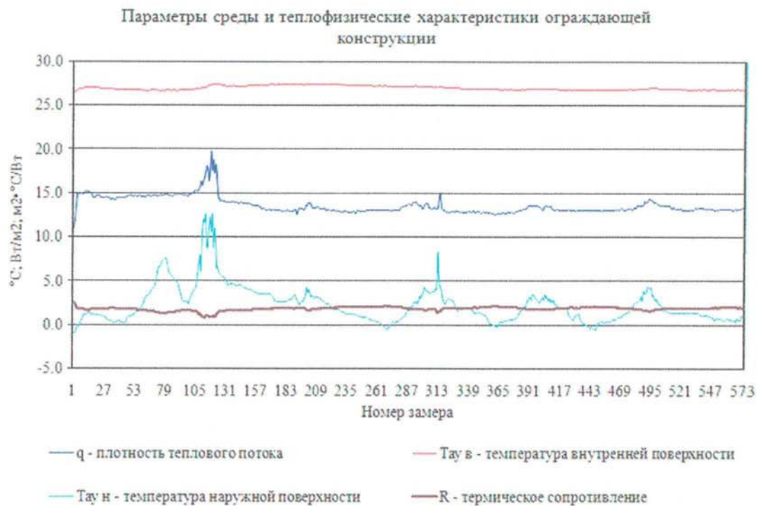
Рисунок 10. Теплофизические характеристики радиаторных участков наружных стен до установки отражающих экранов
